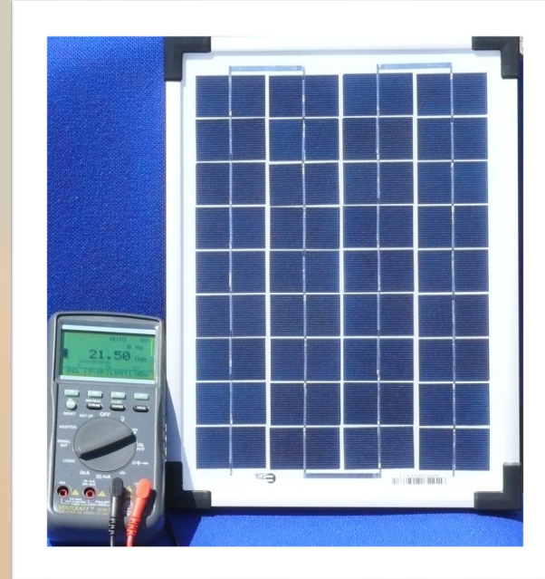
Elektrische Übertragungsmessung nach der Beschichtung
